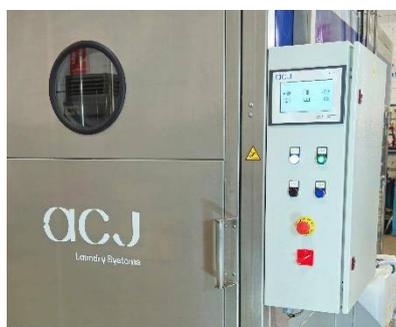
Todos los componentes tñnicos estñ ubicados dentro de la mñquina y son accesibles a travñ de sus grandes puertas. Y mñ añ; todos los componentes se ubican en un lado, de modo que la mñquina se puede montar muy cerca de una pared en un lado.
